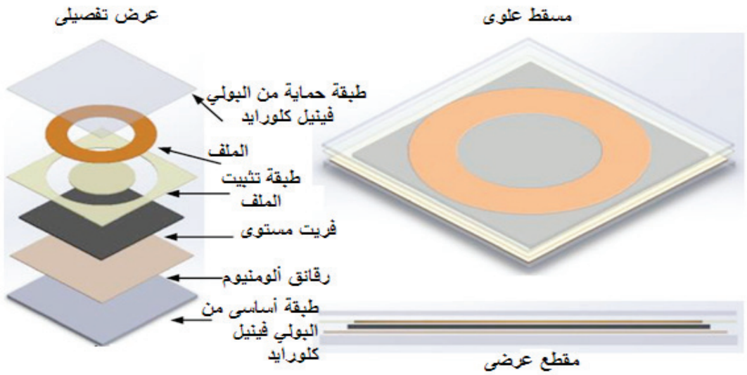
الشكل (6) طبقات لوحة الإرسال / لوحة الاستقبال في أنظمة الشحن اللاسلكية
