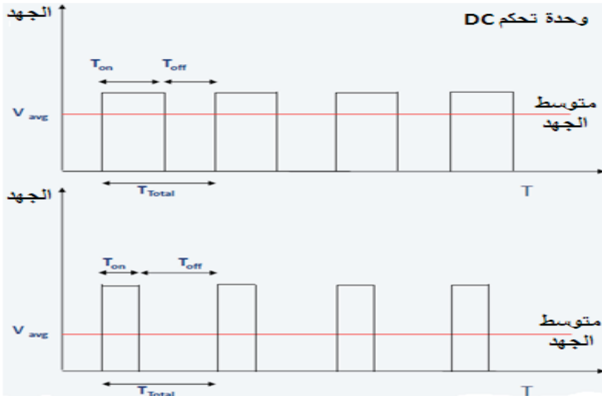
شكل (6) عمل وحدة تحكم بالتيار المستمر باستخدام (PWM) (Courtesy: howstuffworks.com)
