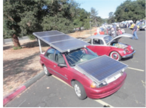
مجموعة من الخلايا الشمسية مركبة على سقف السيارة وعلى المقدمة
