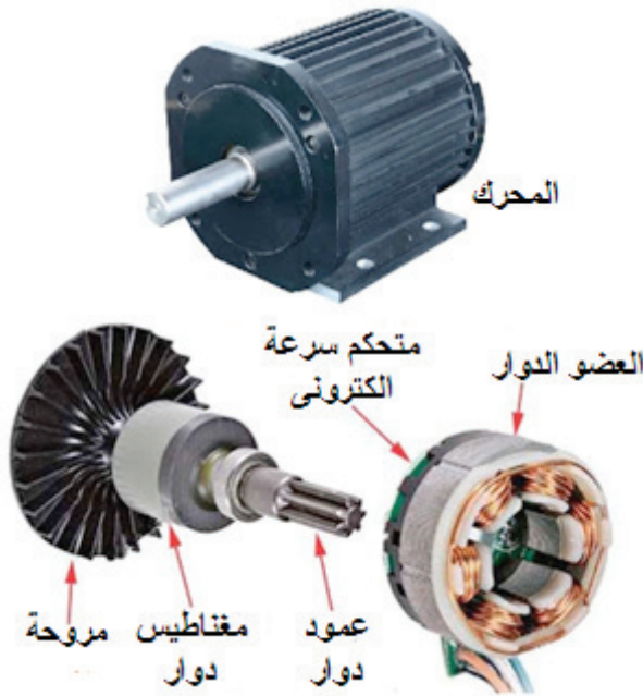
شكل (11) مكونات محرك تيار متردد بدون فرش
